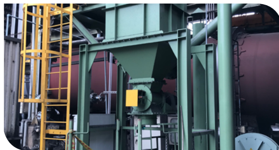
2K 空冷窯新製集塵機工程
